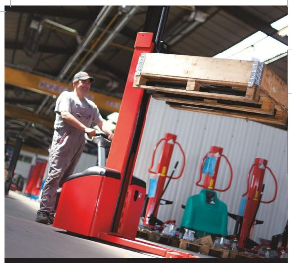
ELECTRICAL MONO MAST STACKER - 24V - 1000 Kg
